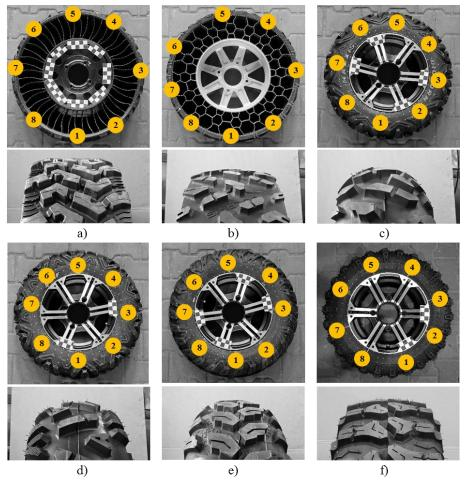
Fig. 2. Research objects/wheels: a) NPT 1, b) NPT 2, c) PT 1, d) PT 2, e) PT 3, f) PT 4.
