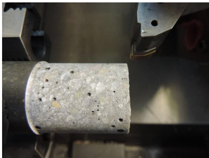
Rysunek 3. Widok zamontowanej próbki odlewu mineralnego
