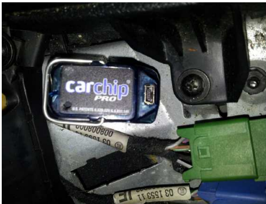
Rys. 3. Urządzenie rejestrujące CarChip Pro w gnieździe OBD pojazdu
