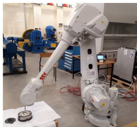
Rys.8. a) Idea działania systemu smarowania wraz z przykładowym schematem cyklu pracy, b) wykorzystanie ramienia manipulatora do ukierunkowanego podawania środka smarno-chłodzącego
