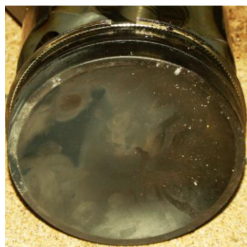
Rys. 4. Widok elementów pierwszego cylindra silnika Caterpillar 3516A ze śladami zatarcia (fot. autora):
