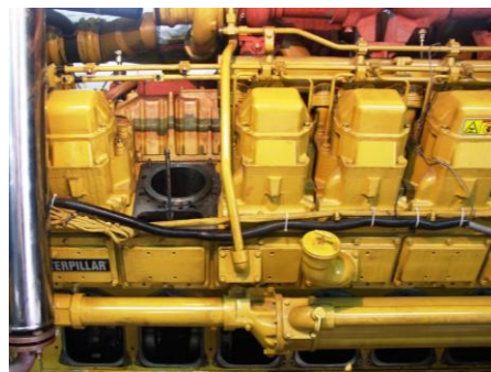
Rys. 3. Silnik dwupaliwowy Caterpillar 3516A w trakcie awarii pierwszego cylindra (fot. autora):
