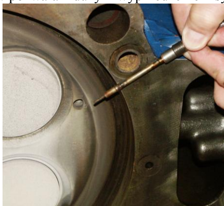
Rys. 6. Monitorowanie obciążenia cieplnego cylindra gazowego silnika f-my Deutz (fot. autora)
