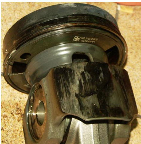
Rys. 5. Tłok dwupaliwowego silnika Caterpillar 3516A zatarty wskutek awarii układu chłodzenia olejowego denka (fot. autora)
