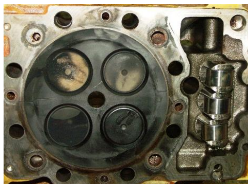
Rys. 4. Widok elementów pierwszego cylindra silnika Caterpillar 3516A ze śladami zatarcia (fot. autora):
