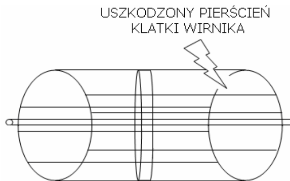
Rys. 6. Uszkodzony pierścień klatki wirnika silnika synchronicznego
