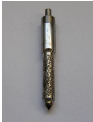
Rys. 4. Iglica z naniesioną powłoką katalityczną na niepracującej części [8]
