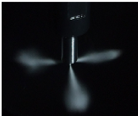
Rys. 6. Struga wtryskiwanego paliwa we wtryskiwaczu z naniesioną powłoką katalityczną
