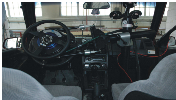
Rys. 1 Schemat wyposażenia badawczego w samochodzie oraz instalacja robota do sterowania. Oznaczenia: 1, 2 – wieloelementowe dynamometry na kołach jezdnych, 3 – robot sterujący na kole kierownicy, 4 – terminal obsługi, 5 – komputer centralny, 6 – system DGPS, 7 – moduł zasilający.
