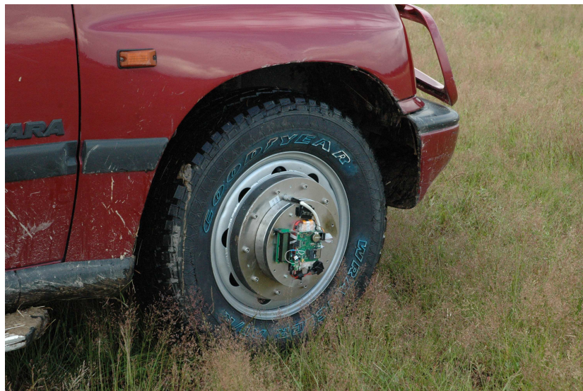
Rys. 1 Dynamometr wielokładnikowy na kole jezdnym podczas pomiaru momentu M_y na lotnisku trawiastym
