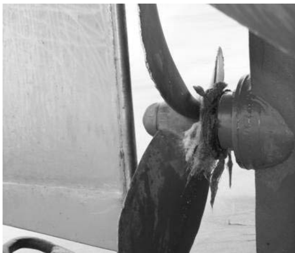
Rys.9. Lina nawinięta na wał śrubowy łodzi rybackiej Fig 9. Line that fouled a propeller shaft of a fishing boat
