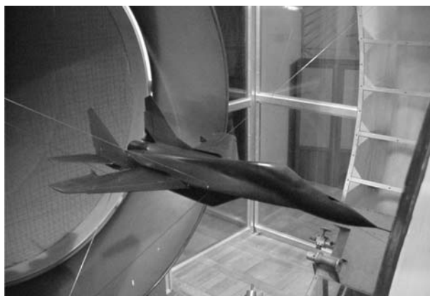
Rys. 15. Widok modelu samolotu MiG-29 zawieszony w przestrzeni pomiarowej tunelu aerodynamicznego Fig. 15. View of aircraft MiG-29 situated in measurement space of wind tunnel
