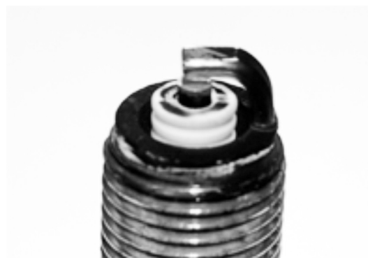
Fot. 2. Świeca zapłonowa ze zmodyfikowanym izolatorem po przeprowadzeniu próby samooczyszczania Phot. 2. Spark plug with modified insulator after the self-cleaning test
