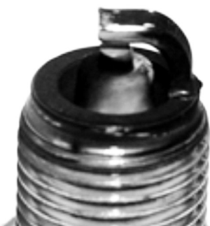
Fot. 1. Świeca zapłonowa U-super po przeprowadzeniu próby samooczyszczania Phot. 1. U-super spark plug after the self-cleaning test
