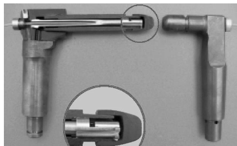
Rys.7. Przetworniki ultradźwiękowe umieszczone wewnątrz elektrod [3]
